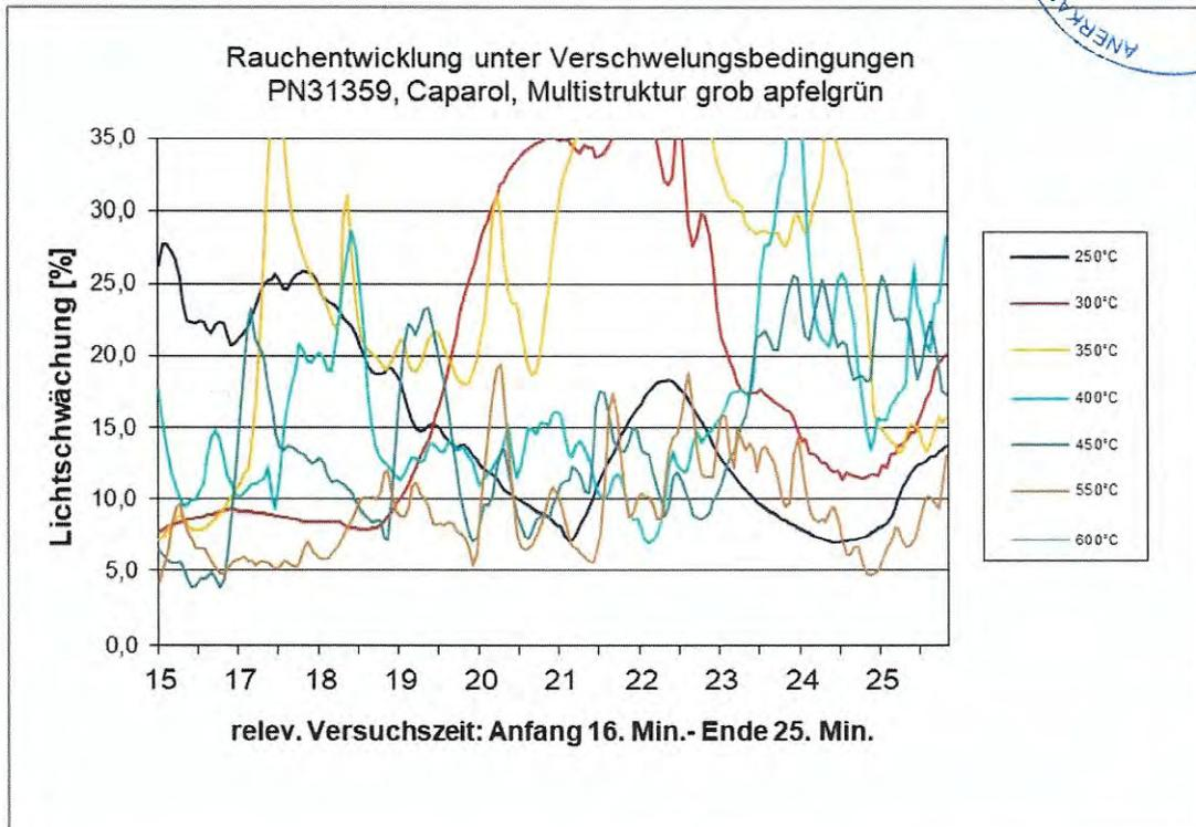
**5.4 Prüfung zur Bestimmung der Rauchentwicklung von Baustoffen – Verbrennung bei Flammenbeanspruchung (DIN 4102, Teil 1, Anhang B)**
